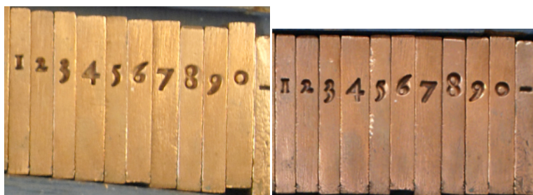
FIGURE 26. — Ces matrices du Garamond (conservées au musée Plantin-Moretus, Anvers) montrent des chasses variables pour les chiffres. À gauche, Gros Canon Romain de Garamont, 1549 ; à droite, Moyen Canon de Van den Keere, ≈ 1600. Photos J.A. et Frank Blokland (voir aussi [36]).
